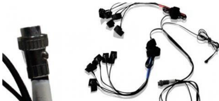
Ein Handkabel zum Messen der Handpotenziale
